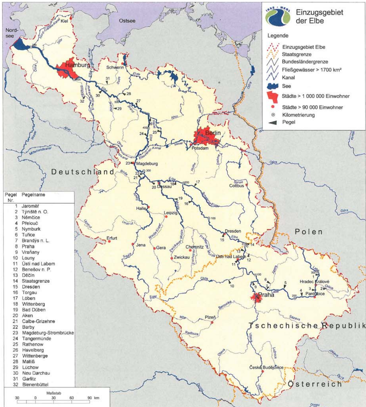
Abb. 4: Lage ausgewählter Pegelstationen im Einzugsgebiet der Elbe für die Berechnung hydrologischer Charakteristika
