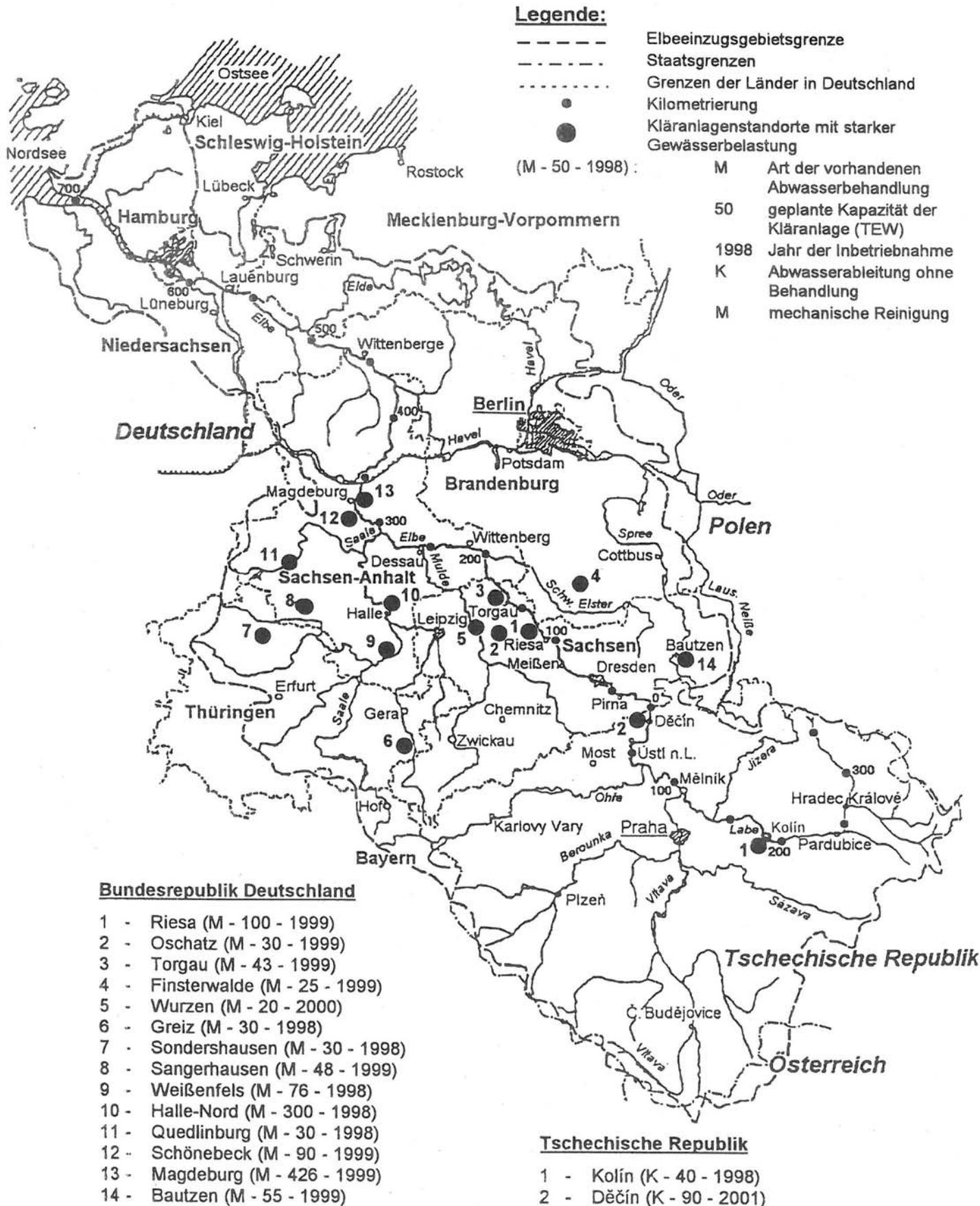
**Abb. 1: Sanierungsschwerpunkte kommunaler Abwassereinleitungen über 20 TEW im Einzugsgebiet der Elbe, an denen die Abwasserableitung entweder ohne Behandlung (K) oder nur mit mechanischer Behandlung (M) erfolgt (Stand Dezember 1997)**
