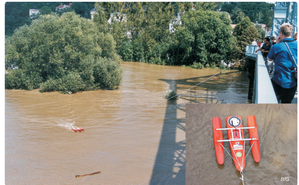
Abb. 5.1-17: Abflussmessung mittels Ultraschallgerät (ADCP) in Dresden beim Hochwasser im August 2002
