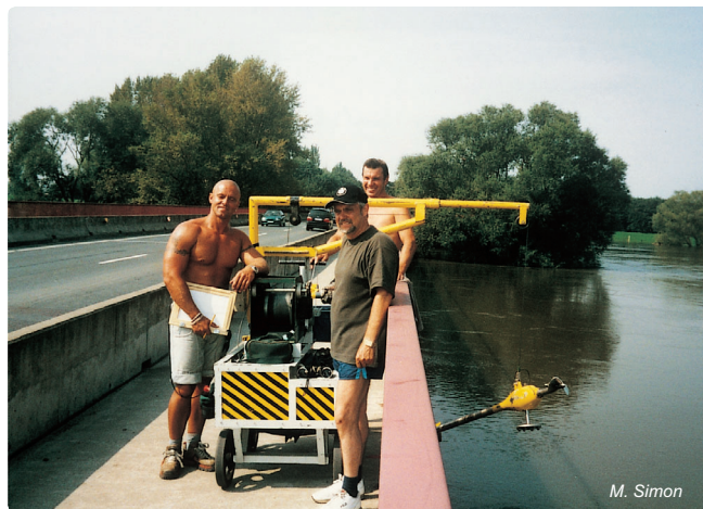
Abb. 5.1-16: Flügelmessungen am Elbeumflutkanal bei Magdeburg beim Hochwasser im August 2002
