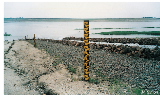
Abb. 5.1-10: Staffelpegel zur Kontrolle der Flutung des Tagebaus Goitzsche aus der Mulde bei Bitterfeld
