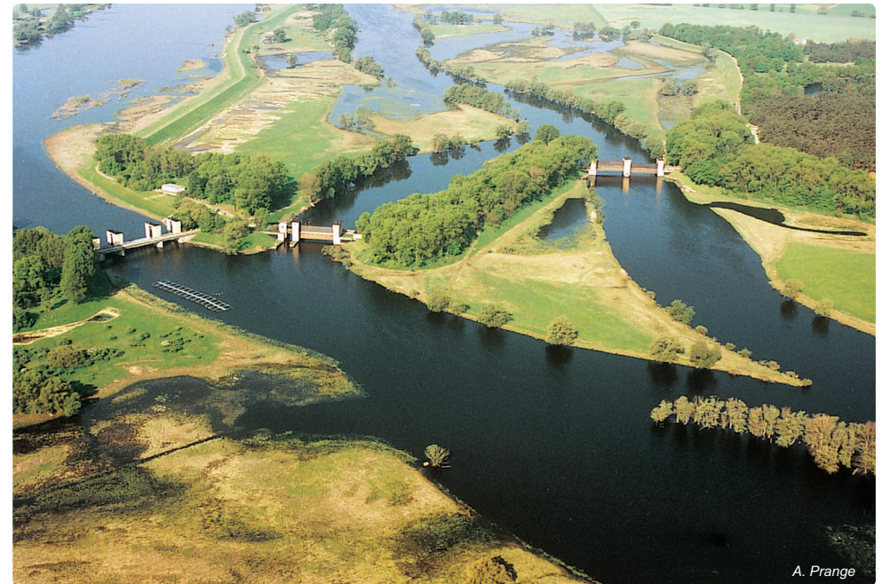
Abb. 4.9-37: Wehrgruppe Quitzöbel mit Einlasswehr Neuwerben (links) sowie Altarm- und Durchstichwehr in der Havel
