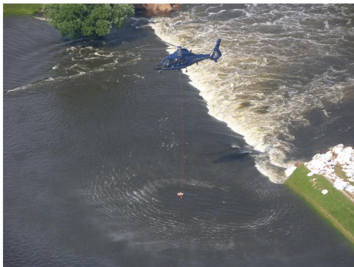
Abb. 3.9-4: Durchflusssmessung vom Hubschrauber aus an der Deichbruchstelle Fischbeck (Quelle LHW ST)
