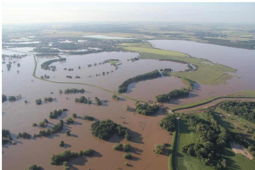
Abb. 3.6-5: Dammbrech und Flutung des Seelhausener See aus der Mulde am 5. Juni 2013 (Quelle: Günther Bauer)
