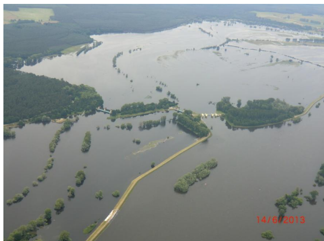
Abb. 3.10-1: Großflächige Überschwemmungen um die Wehrgruppe Quitzöbel – Mit dem Einlasswehr Neuwerben steuert der LHW Sachsen-Anhalt die Flutung der Havelniederung. Die Havelniederung umfasst den Havelschlauch und sechs Havelpolder. (Quelle: LHW ST)
