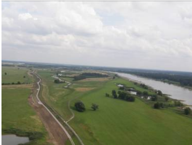
Abb. 2.1-5: Blick auf die Deichrückverlegung Lenzen im Sommer 2009, links Neudeich – rechts Altdeich vor der Öffnung im Jahr 2009 (Foto: LUGV – F.-H. Ullrich)
