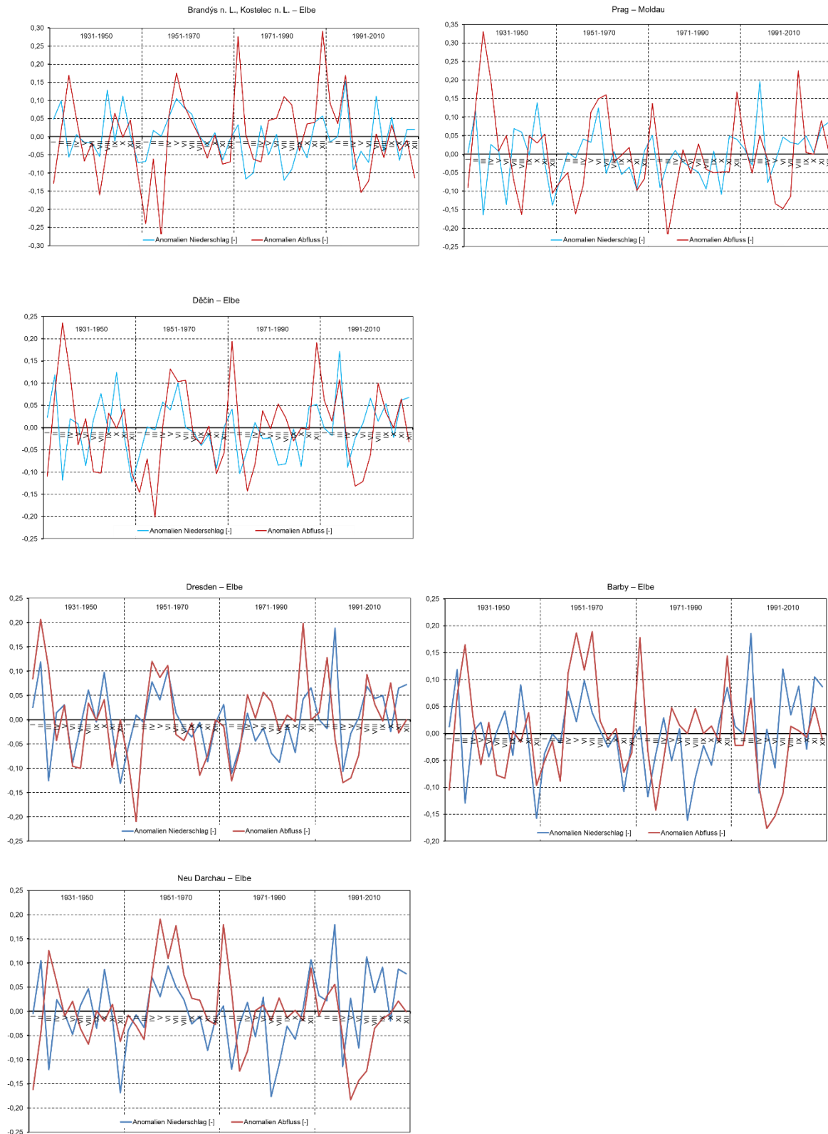
Abbildung 3: Vergleichende Darstellung der Abweichungen von den Pardé-Koeffizienten für Niederschlag (blau) und Abfluss (rot) für die vier 20-Jahresblöcke (Quelle: ČHMÚ, BfG, Niederschlagsdaten: GPCC)
