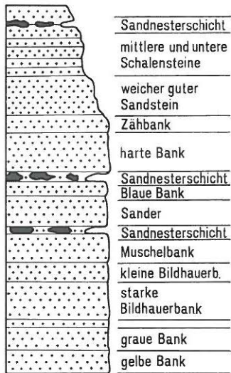
Abb. 5: Steinbruch Lohmgrund I (A25) Aufbau des "Cottaer (Bildhauer-) Sandsteins"
