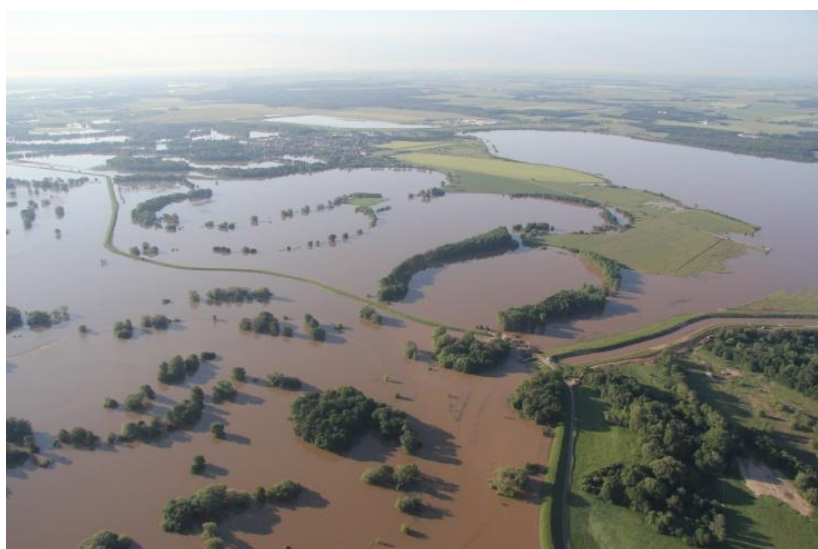
Obr. 3.6-5: Protržená hráz a napouštění jezera Seelhausener See vodou z Mulde dne 5. června 2013 (zdroj: Günther Bauer)
