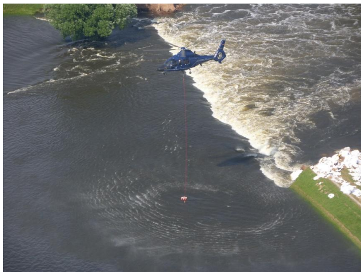
Obr. 3.9-4: Měření průtoku vrtulníkem v lokalitě protržené ochranné hráze u obce Fischbeck (zdroj: LHW ST)
