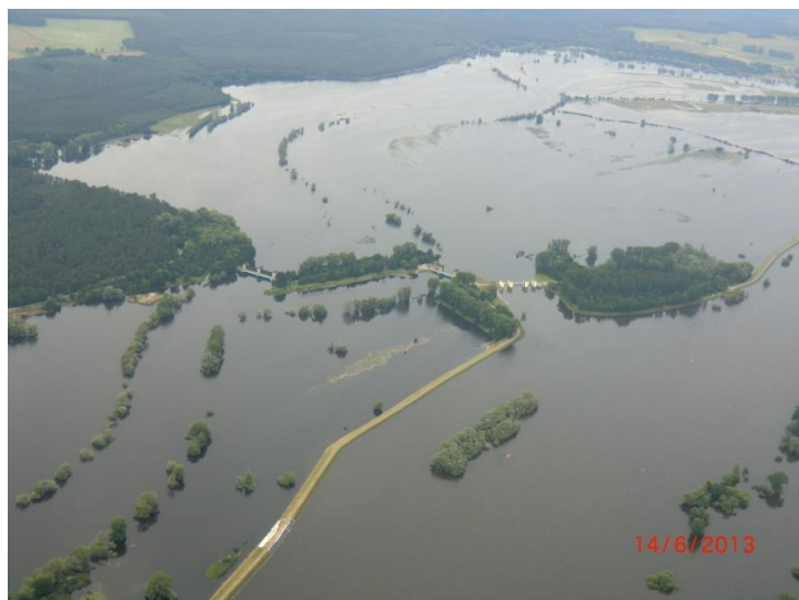
Obr. 3.10-1: Rozsáhlé rozlivy kolem jezové soustavy Quitzöbel – Zemský podnik povodňové ochrany a vodního hospodářství (LHW) Saska-Anhaltska řídí vtokovým jezem Neuwerben napouštění havolské nížiny. Havolská nížina zahrnuje koryto Havoly a 6 poldrů na Havole. (zdroj: LHW ST)
