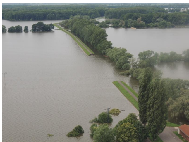
Obr. 3.7-13: Letecký snímek ze dne 13. června 2013 ukazuje místo protržené pravostranné ochranné hráze na Sále u obce Breitenhagen. Vpravo dole je vidět čerpací stanice Breitenhagen. (zdroj: LHW ST)
