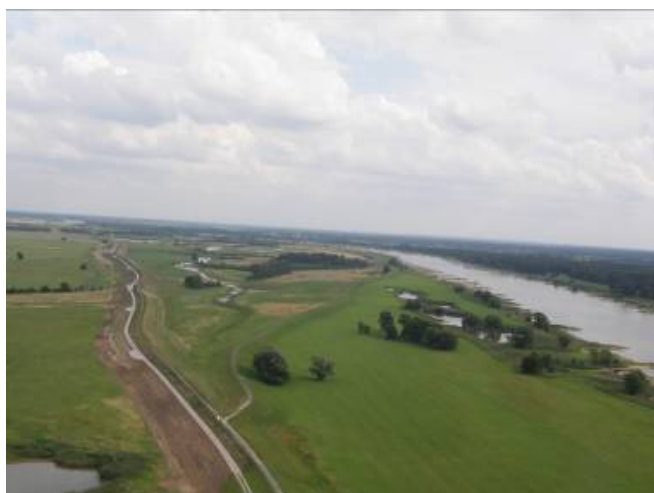
Obr. 2.1-5: Pohled na oddálení hráze od toku u obce Lenzen v létě 2009, vlevo nová hráz – vpravo stará hráz před otevřením v roce 2009 (foto: LUGV – F.-H. Ullrich)
