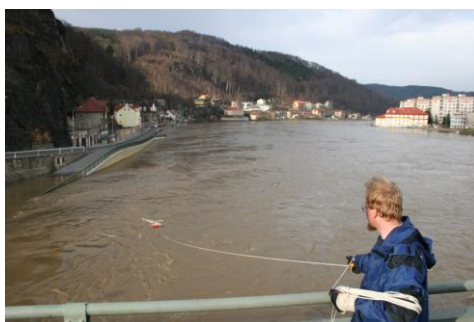
Obr. 4.2-2: Měření průtokoměrem ADCP na Labi v Děčíně – povodeň 2006 (zdroj: ČHMÚ??)
