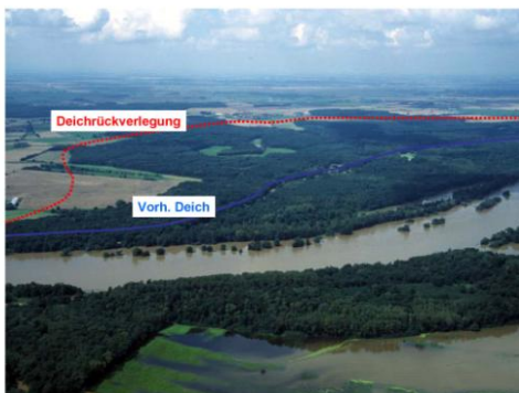
Obr. 2.5-13: Oddálení ochranné hráze od toku v lokalitě Lödderitzer Forst (zdroj: Zemský podnik povodňové ochrany a vodního hospodářství Saska-Anhaltska)
