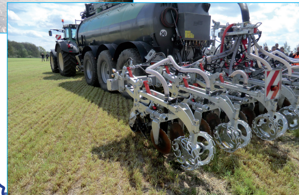
4 Metoda pásového zpracování půdy (strip-till) – aplikace menšího množství kejdy díky úspornému zapravování kejdy do půdy zdroj: LEJE
