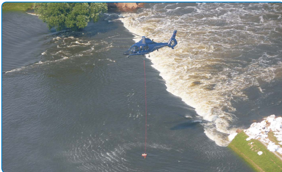
Obr. 3.9-4: Měření průtoku z vrtulníku v lokalitě protržené ochranné hráze u obce Fischbeck – zdroj: LHW ST
