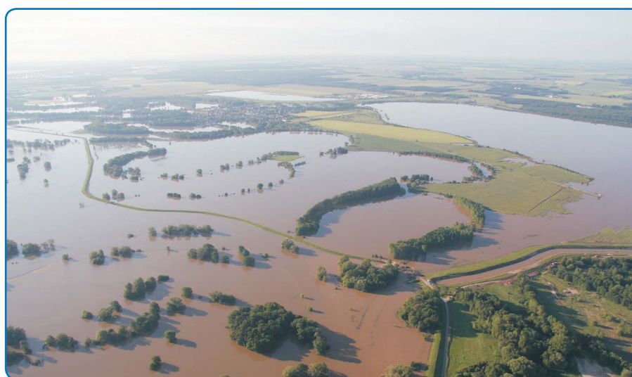
Obr. 3.6-5: Protřzená hráz a napouštění jezera Seelhausener See vodou z Mulde dne 5. 6. 2013 zdroj: Günther Bauer
