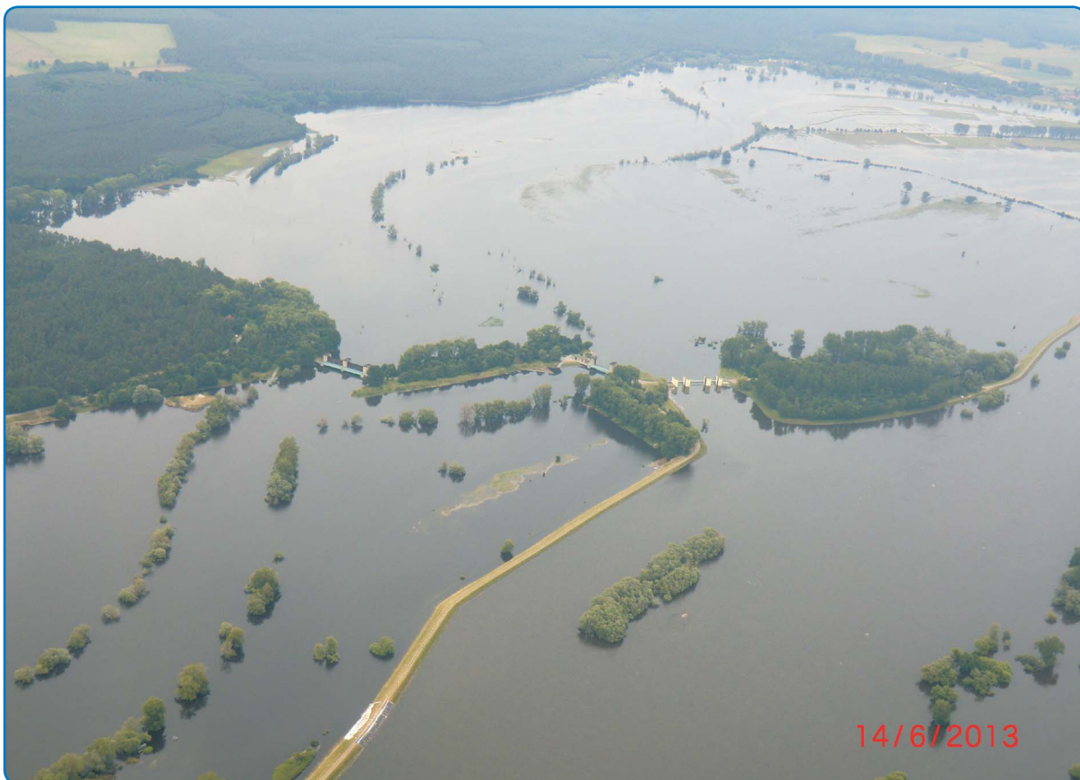
Obr. 3.10-1: Rozsáhlé rozlivy kolem jezové soustavy Quitzöbel. Zemský podnik povodňové ochrany a vodního hospodářství (LHW) Saska-Anhaltska řídí vtokovým jezem Neuwerben napouštění Havolské nížiny. Havolská nížina zahrnuje koryto Havoly a 6 poldrů na Havole. – zdroj: LHW ST
