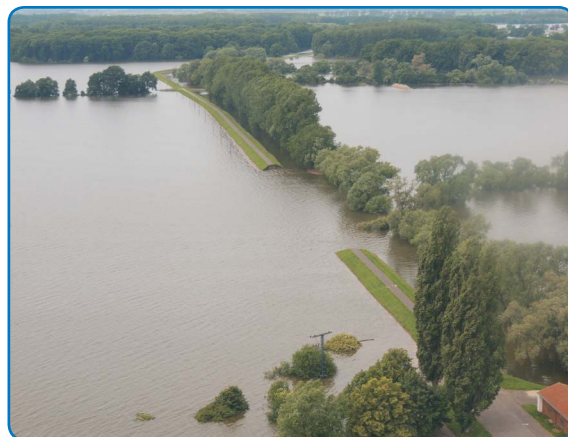
Obr. 3.7-13: Letecký snímek ze dne 13. 6. 2013 ukazuje místo protržené pravostranné ochranné hráze na Sále u obce Breitenhagen. Vpravo dole je vidět čerpací stanici Breitenhagen. zdroj: LHW ST
