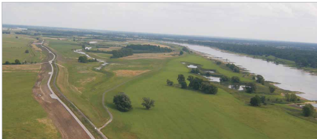
Obr. 2.1-9: Pohled na oddálení hráže od toku u obce Lenzen v létě 2009, vlevo nová hráz – vpravo stará hráz před otevřením v roce 2009 (foto: LUGV)
