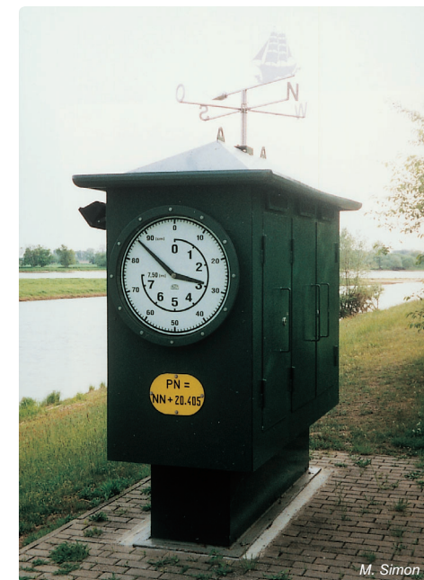
Obr. 5.1-13: Vodočetné hodiny na soutoku Labe s Havolou na jezu Neuwerben, aktuální vodní stav: 286 cm
