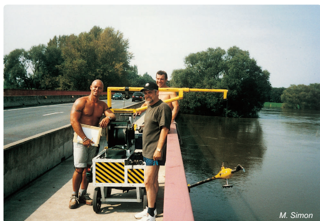
Obr. 5.1-16: Měření vrtulí na obtokovém kanálu Labe u Magdeburku při povodni v srpnu 2002
