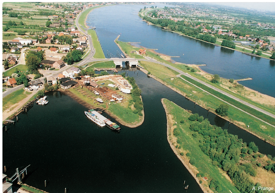
Obr. 4.11-7: Ústí řeky Ilmenau s uzavíracím jezem proti bouřlivým přílivům
