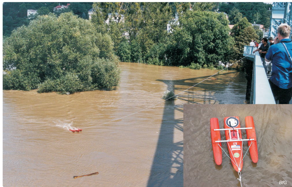
Obr. 5.1-17: Měření průtoků ultrazvukem (ADCP) v Drážďanech při povodni v srpnu 2002
