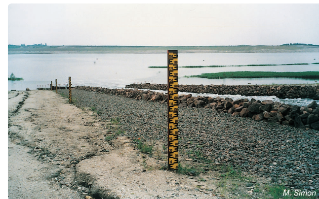
Obr. 5.1-10: Stupňovitý vodočet ke kontrole zatápění důlního jezera Goitzsche vodou z Mulde nedaleko Bitterfeldu
