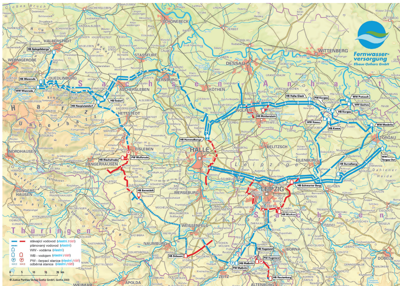
Obr. 4.4-25: Soustava dálkové vodovodní sítě v labské nivě u Torgau a východní části Harcu ve správě podniku Fernwasserversorgung Elbaue-Ostharz GmbH
