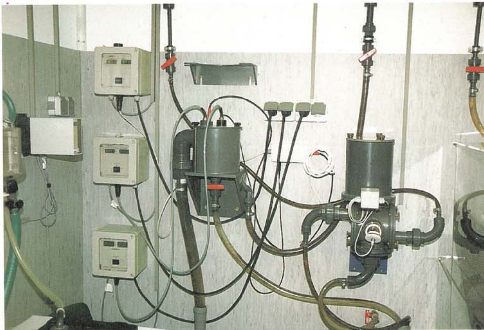
Abb. 9: Meßtopf und Trübungsmeßgerät
