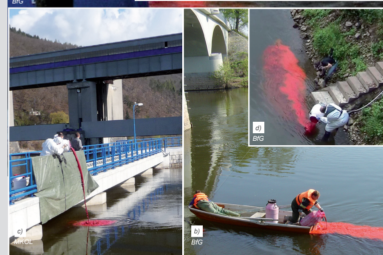
Vypuštění značkovací látky Sulforhodamin G a) dne 6. 10. 2004 v profilu Mauken, pokus se značkovací látkou v úseku Mauken – Geesthacht b) dne 2. 5. 2005 v profilu Němčice, pokus se značkovací látkou v úseku Němčice – Píra c) dne 17. 4. 2013 v profilu Vrané, pokus se značkovací látkou na Vltavě d) dne 13. 8. 2013 v profilu Naumburg-Henne, pokus se značkovací látkou na Sále
